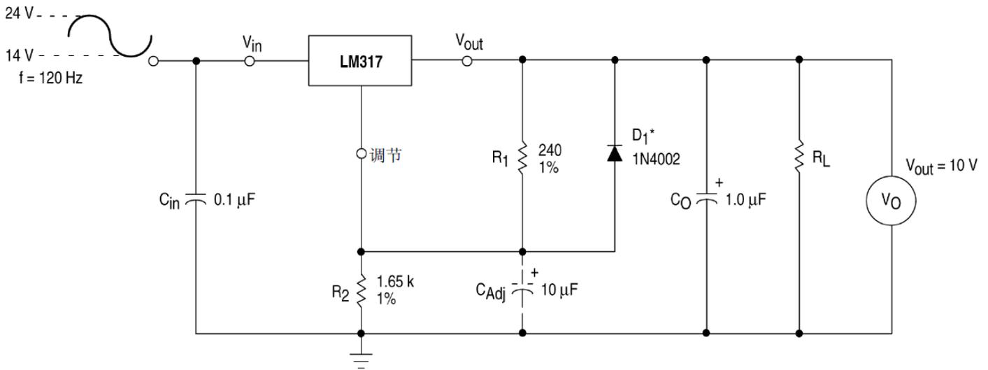
\*D<sub>1</sub> 使 C<sub>Adj</sub> 放电,若输出短接到地。
