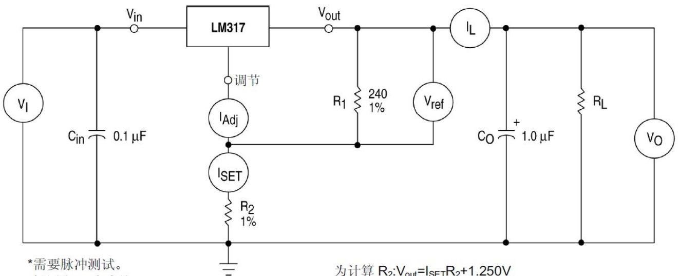
为计算  $R_2: V_{out}=I_{SET}R_2+1.250V$
